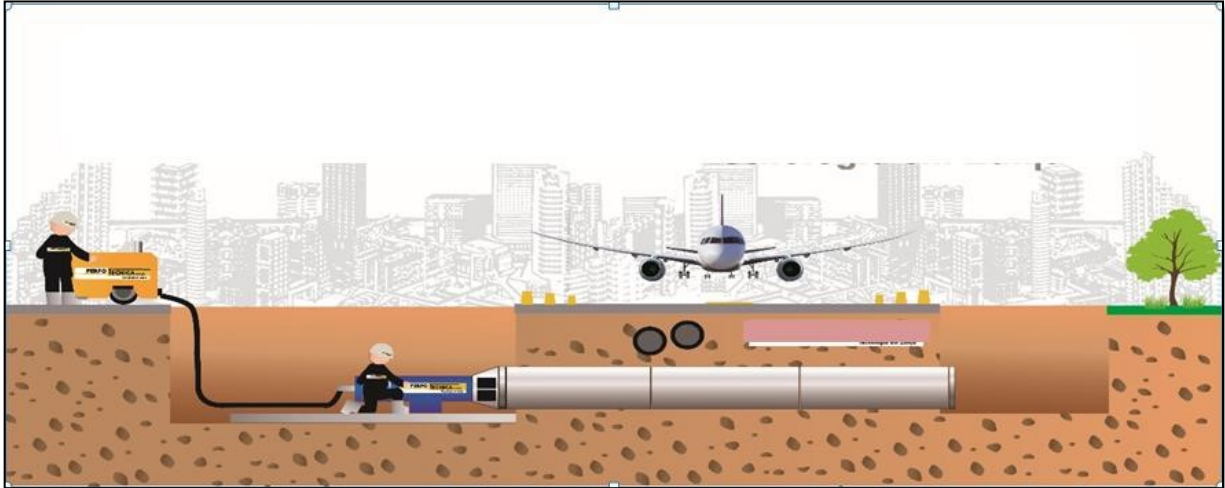
Figura 23. Proceso de Perforación a usar en el colector nororiental (Canal 8) Proyecto Calle 63 A- Ramming
