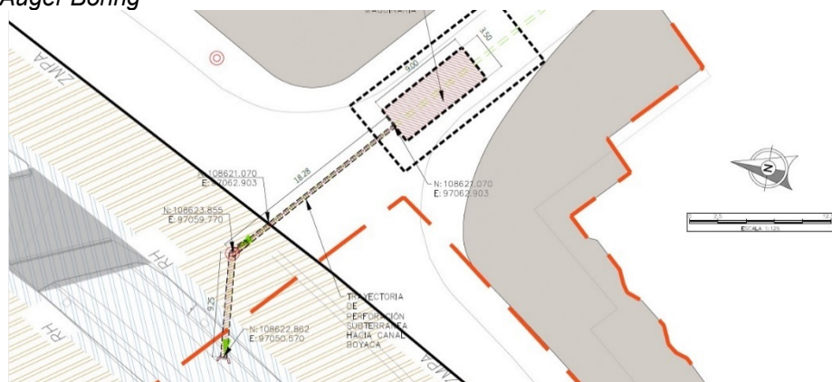
Figura 25. Localización de Excavación para Perforación Colector Suroriental Calle 63 Bis (Entrega Canal) - Auger Boring
