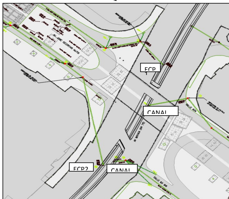
Figura 21. Resumen-Proyectado alcantarillado pluvial entregas sobre canal Boyacá
