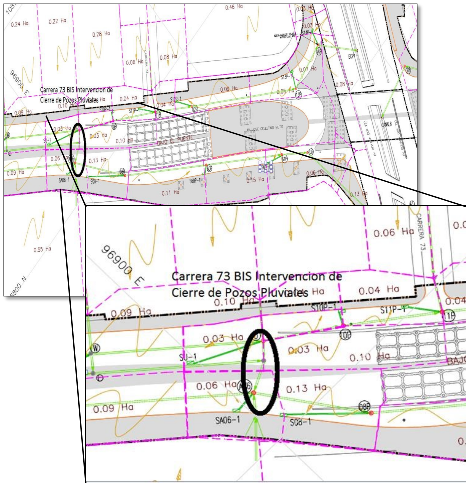
Figura 6. Vista General Zona de inicio de Intervención y cierre de Pozos Pluviales Colectores Sector Occidental
